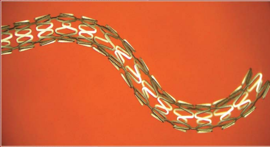
4. kép: Az FMC 18 Sanocor Stent hajlékonysága (polírozás előtt)
